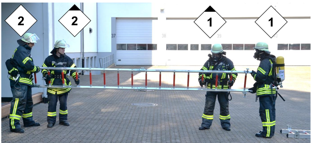
Abbildung 39: Drehen der unteren Multifunktionsleiter
