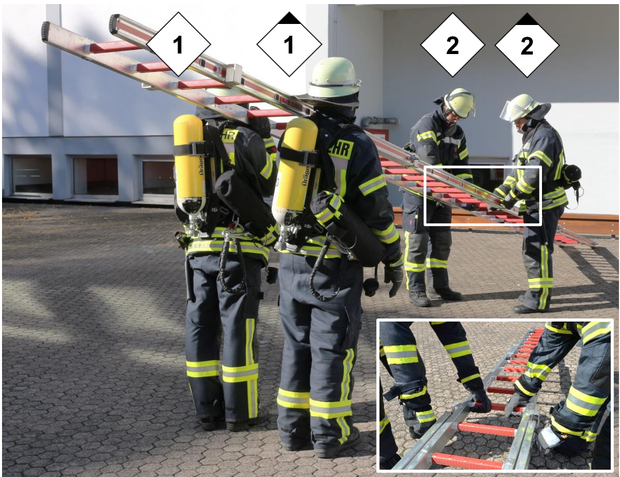
Abbildung 11: Zusammenstecken der Steckleiterteile
