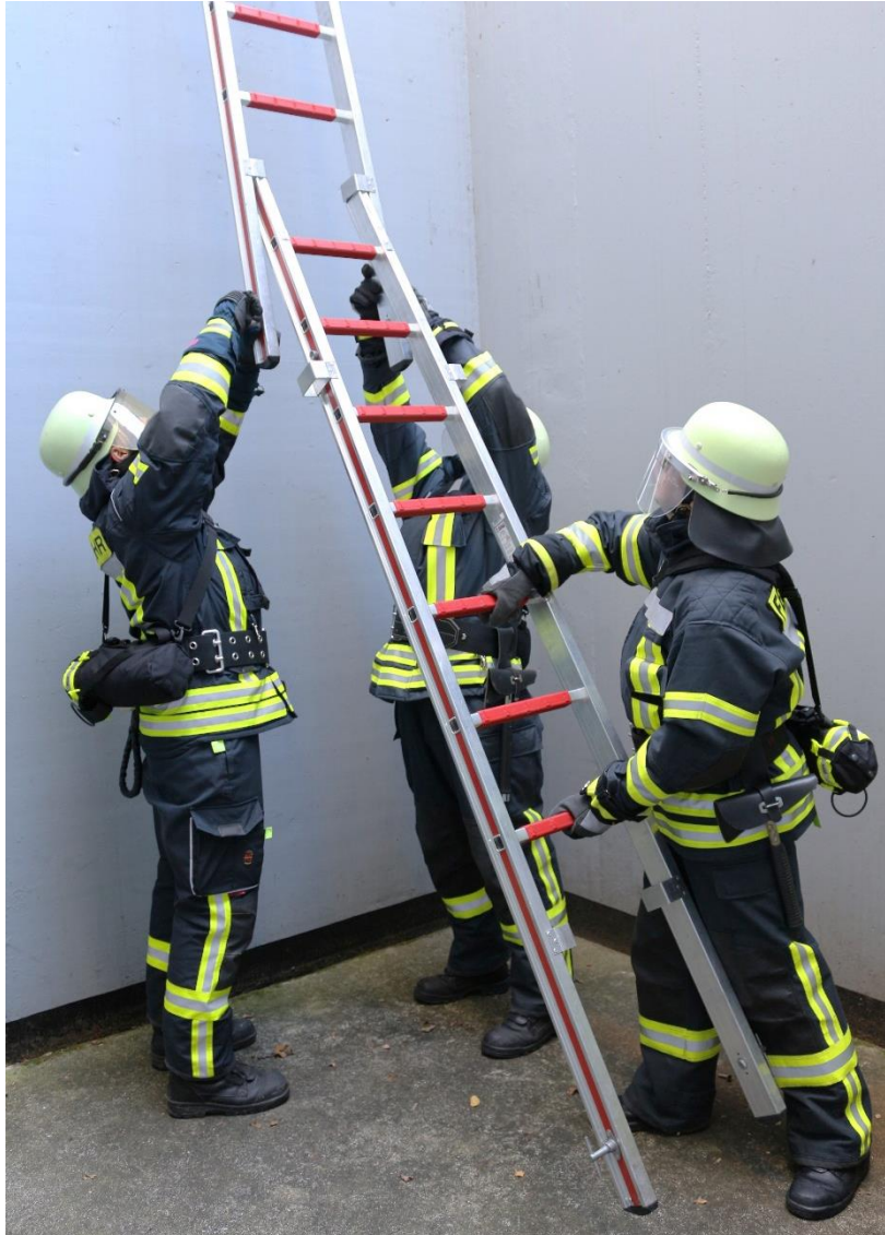
Abbildung 16: Einstecken eines Leiterteils am Leiterfuß
