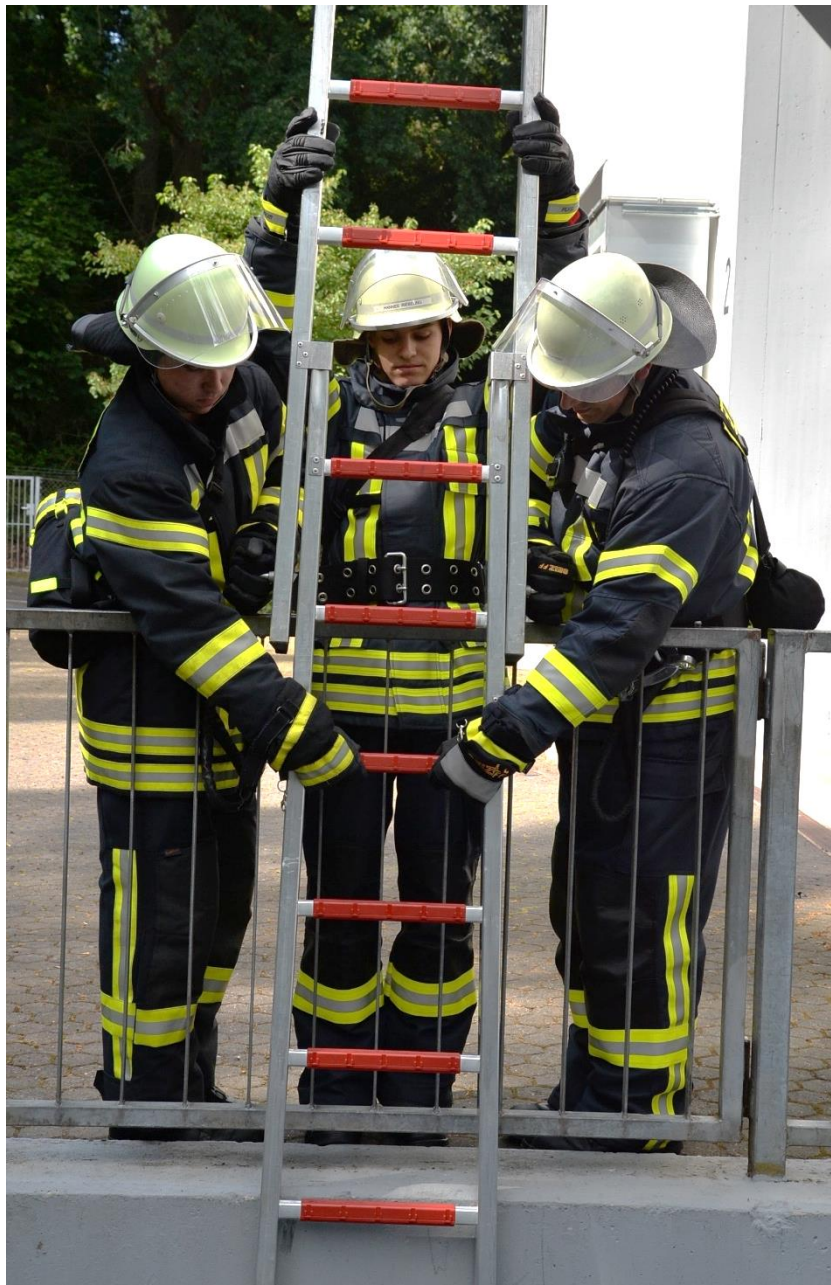
Abbildung 18: Aufstecken eines Leiterteils
