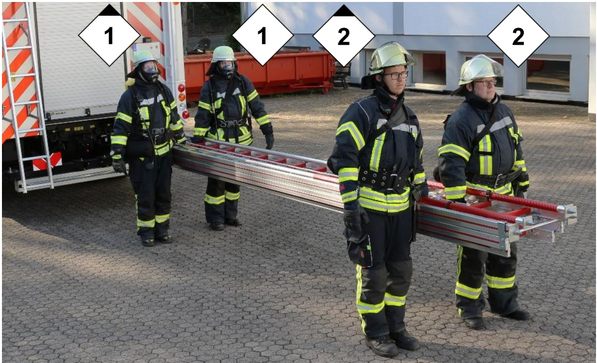
Abbildung 21: Trageweise der Schiebleiter zur Anleiterstelle
