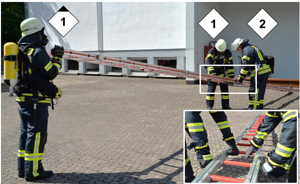
Abbildung 6: Zusammenstecken der Steckleiterteile
