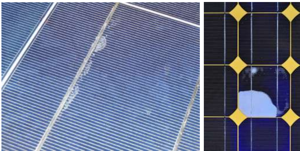
Bild 5-19: Beispiel: Delamination nahe eines Bus-Bars.
