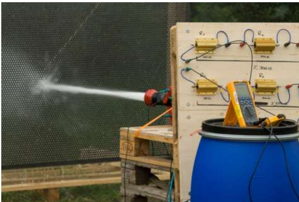
Bild 4-9: Versuchsaufbau mit simuliertem Körperwiderstand zur Messung der Ableitströme über den Löschstrahl
