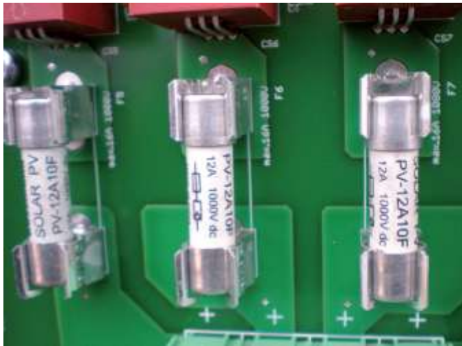
Bild 3-52: PV-Sicherung nach Norm [Quelle: SIBA]
