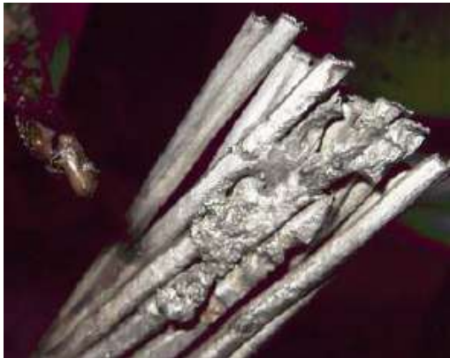
Bild 3-29: Das Ende einer Aluminiumleitung (Foto: Uli Motzer, Württembergische Versicherung)
