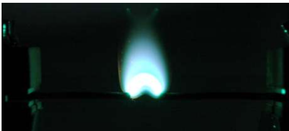
Bild 2-1: Stabiler DC-Lichtbogen zwischen Kupferelektroden, Foto: TÜV Rheinland
