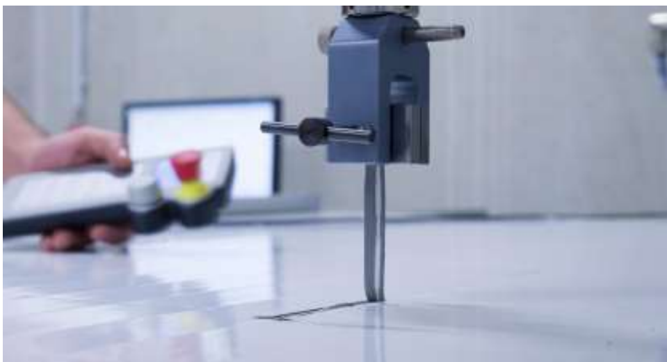
Bild 5-16: Teststand zur Prüfung der Abzugskraft
