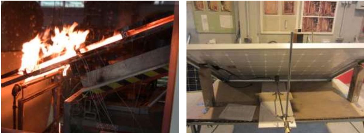
Bild 3-5: links: Versuchsaufbau TÜV/Currenta mit Flächenbrenner, Foto: TÜV Rheinland, Rechts: Versuchsaufbau BAM mit punktförmigem Gasbrenner in mittlerer Positionierung, Foto BAM [12]
