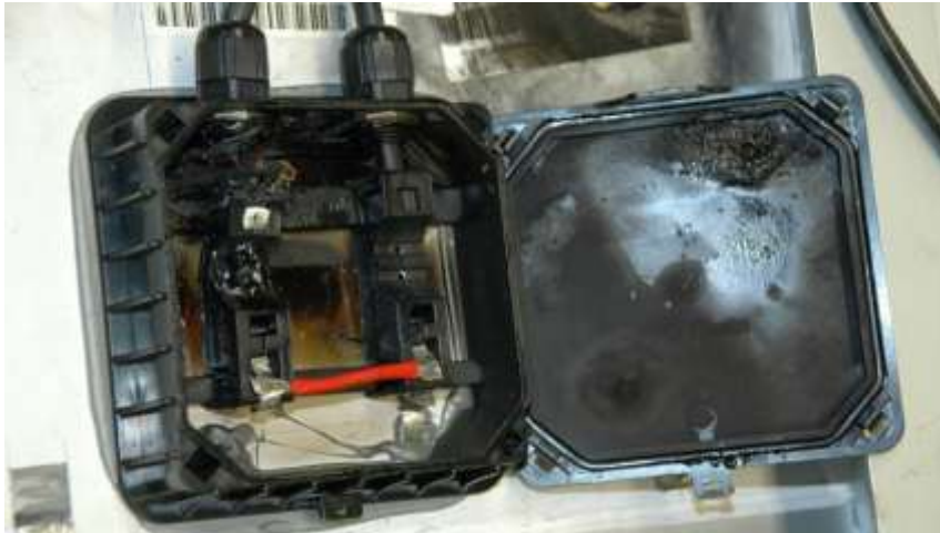
Bild 3-43: Anschlussdose nach Lichtbogen zwischen Anschlussleitung und Anschlussklemme [5]
