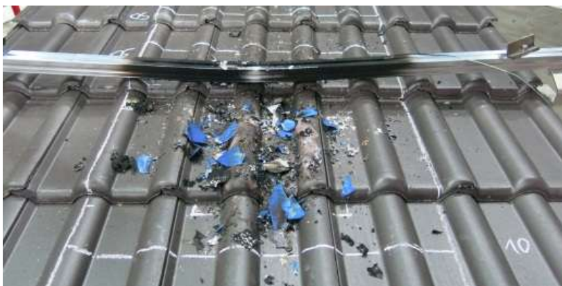
Bild 5-32: Ergebnis nach Prüfung. Modul wurde zerstört, kein Durchbrand in Dachoberfläche
