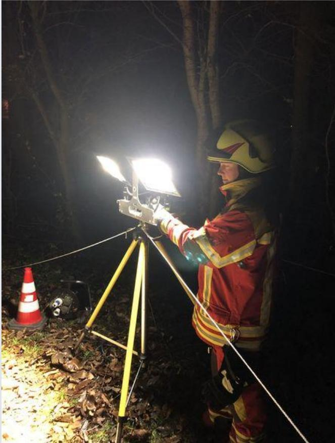
**Stative nicht ausfahren und immer gegen Umfallen sichern (oder festhalten aufgrund des Abwindes des Rotors). Steiler Winkel der Lampen, dadurch besteht eine geringe Blendgefahr der Piloten.**
