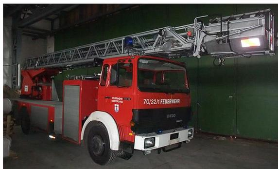
Die Laufleistung beträgt 19521 km, Betriebsstunden = rd. 550, nächste HU = VI/'14, nächste SP = VI/'15, letzte 10-Jahresinspektion = 2009, Standheizung vorhanden. Die letzte jährliche Überprüfung des Fahrzeuges durch die Fa. Magirus hat am 26.09.2013 stattgefunden. Hydraulikschläuche und Rotzler-Winde wurden 2010 erneuert.
