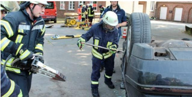
Mit einem Spreizer wird eine deformierte Fahrzeugtür geöffnet, um einen Zugang zur verunfallten Person zu schaffen.
