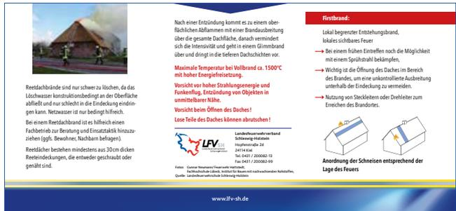
Nach einer Entzündung kommt es zu einem oberflächlichen Abflammen mit einer Brandausbreitung über die gesamte Dachfläche, danach vermindert sich die Intensivität und geht in einem Glühbrand über und dringt in die tiefen Dachschichten vor.
