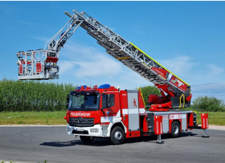
Zur Ausstattung gehören neben der Standard DIN Beladung u.a. eine Schleifkorbtrage, eine Schwerlast-Korbtrage, Rollgliss und ein Satz Absturzsicherung, E-Lüfter, WBK, eine Schuttmulde, die auf dem Korbboden befestigt werden kann, feste Wasserführung über das erste Leiterteil bis hin zu dem über Joystick bedienbaren Werfer am Korb sowie Selbstschuttdüsen. Die gesamte Beleuchtung, bis auf das Fahrlicht nach vorne, ist in LED-Technik ausgeführt.
